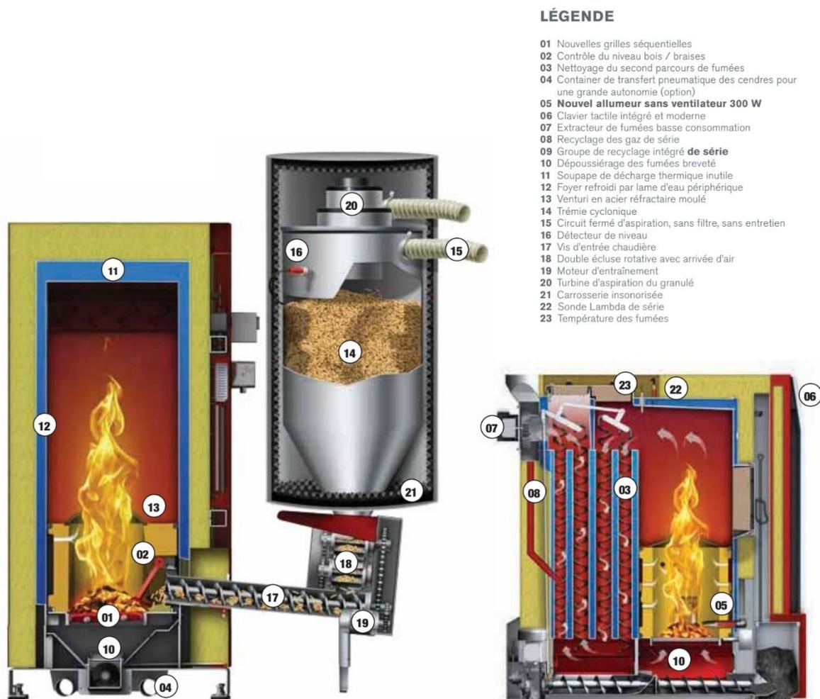
Figure 27 : Schéma d'une chaudière aux granulés bois (source : <http://www.hargassner-france.com>)
