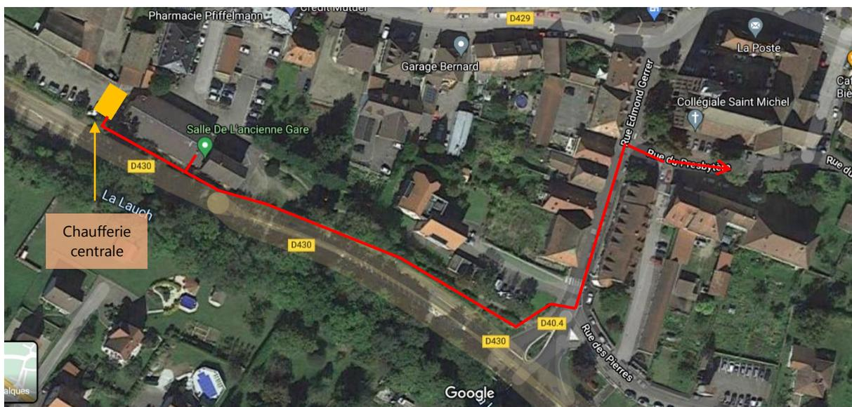
**Figure 21 : Variante B : tracé du réseau de chaleur**
