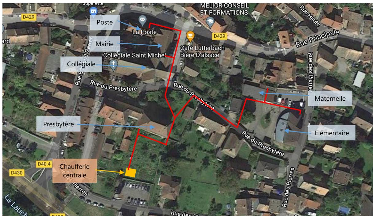
Figure 19 : Variante A : tracé du réseau de chaleur
