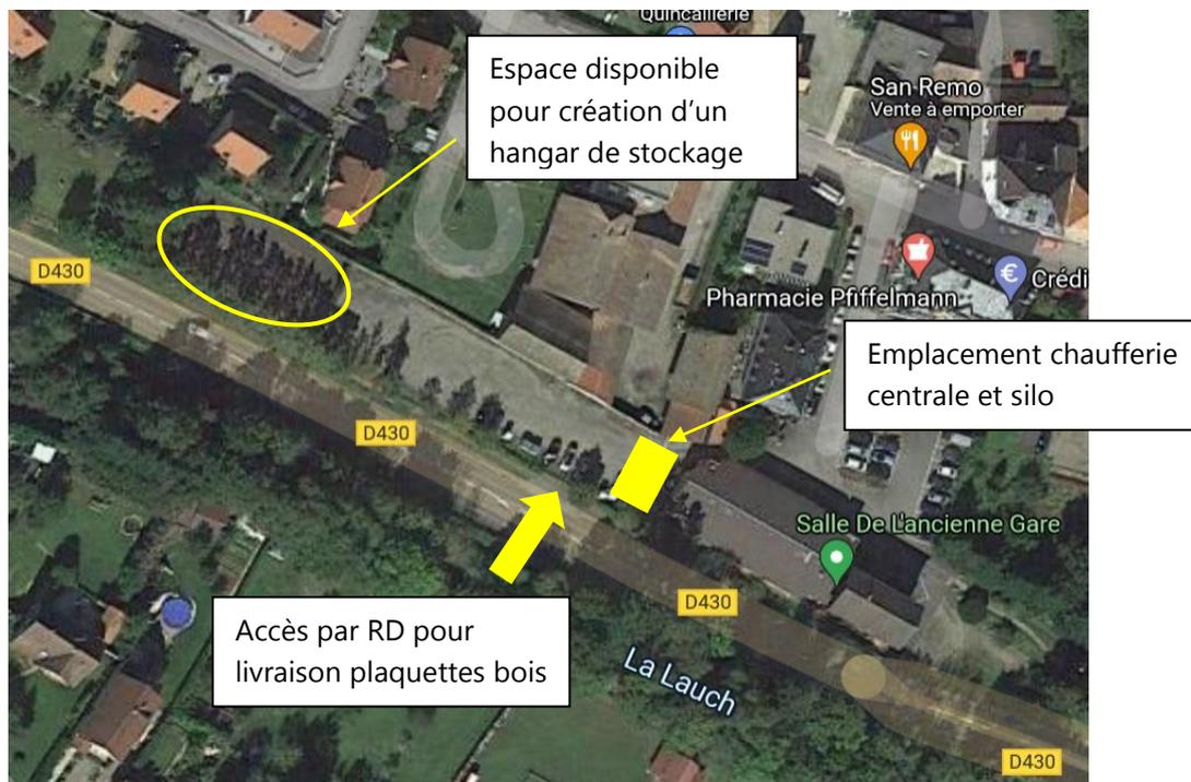
**Figure 18: Variante B : emplacement retenu pour la chaufferie centrale et le silo (source : Google Maps)**
