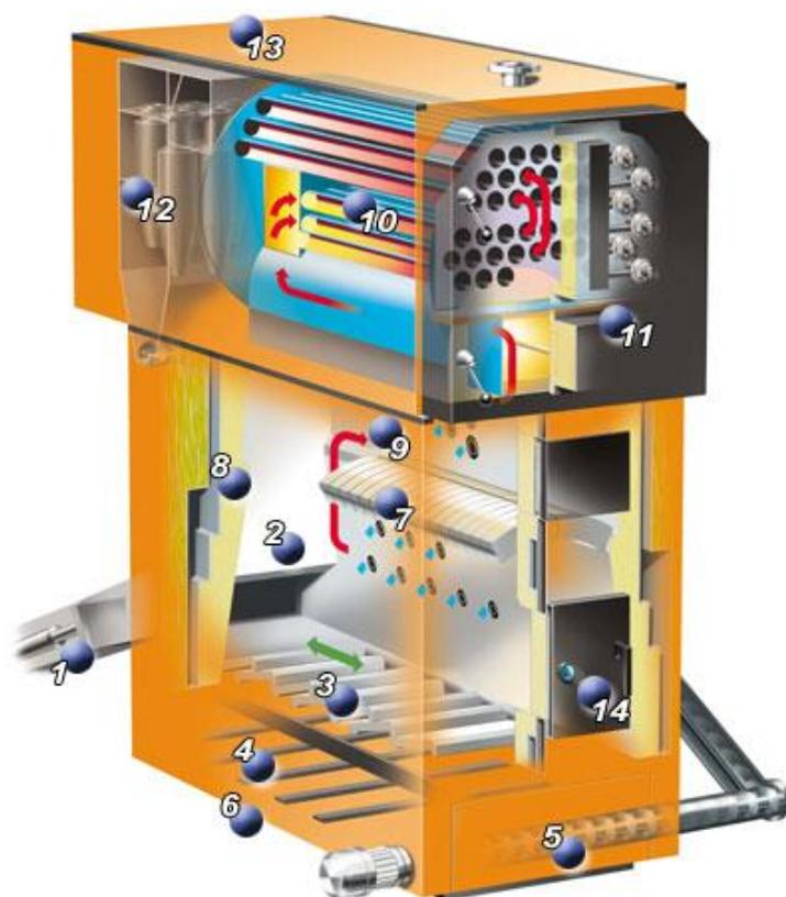
**Figure 26 : Schéma d'une chaudière automatique aux copeaux de bois (source : Schmid, [www.holzfeuerung.ch](http://www.holzfeuerung.ch))**
