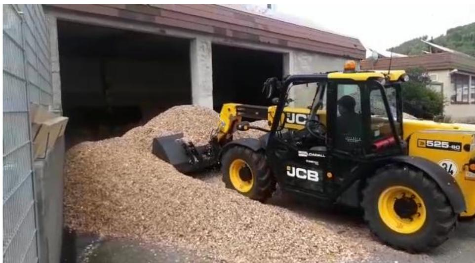
**Figure 25 : Transfert des plaquettes bois, livrées devant le silo, dans le silo avec un chargeur**
